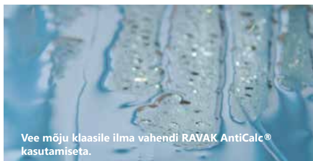
Vahendiga RAVAK AntiCalc® töödeldud klaas – tõrjub vett ja see voolab alla.
